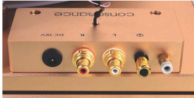
Einer für alles: Das Anschluss-Terminal des Air-1 bietet sowohl die Audioanschlüsse als auch die Verbindungen für Druckluft und Strom an einem einzigen Terminal. Das lässt den noch angenehm kompakten Plattenspieler sehr aufgeräumt und ordentlich wirken.
