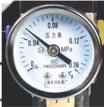
Dass der Air-1 mit einem laufruhigen Mini-Kompressor auskommt, ist seinem überaus geringen Luftverbrauch geschuldet. Dabei ist der Luftdruck am Druckminderer fest voreingestellt. Steht der Kompressor über die etwa drei Meter lange Luftleitung etwas entfernt, wirkt er nicht mehr störend. Um das Ansaugen von Staub zu minimieren, sollte der Druckluftherzeuger übrigens besser nicht auf dem Boden stehen.
