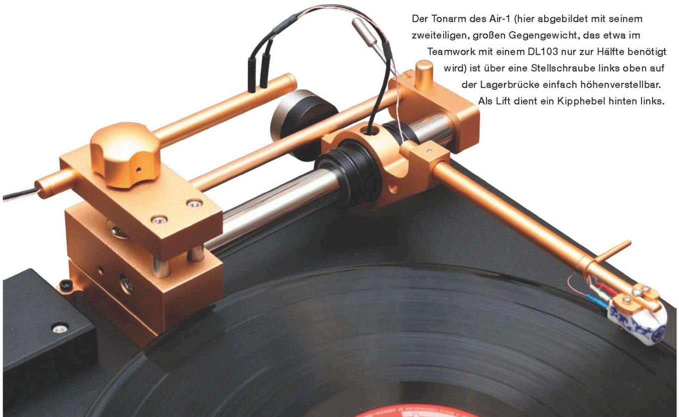
Der Tonarm des Air-1 (hier abgebildet mit seinem zweiteiligen, großen Gegengewicht, das etwa im Teamwork mit einem DL103 nur zur Hälfte benötigt wird) ist über eine Stellschraube links oben auf der Lagerbrücke einfach höhenverstellbar. Als Lift dient ein Kipphebel hinten links.
