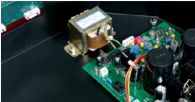
Der SuperClock aus Quartz und nachgeschaltetem Oszillator taktet auch die Servo-Elektronik. Dahinter der Röhrentrafo
